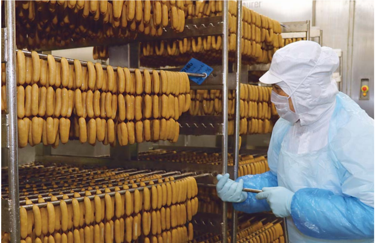
桜の木のチップでのスモークが終わったウインナー。クリーンルーム内でウインナーを整えてカッターにセットし、1本ずつにカットする工程へ進みます
