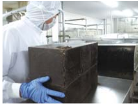
茶色い大きな塊で日本に届いたカカオマスを、専用の機械で温めて溶かします
