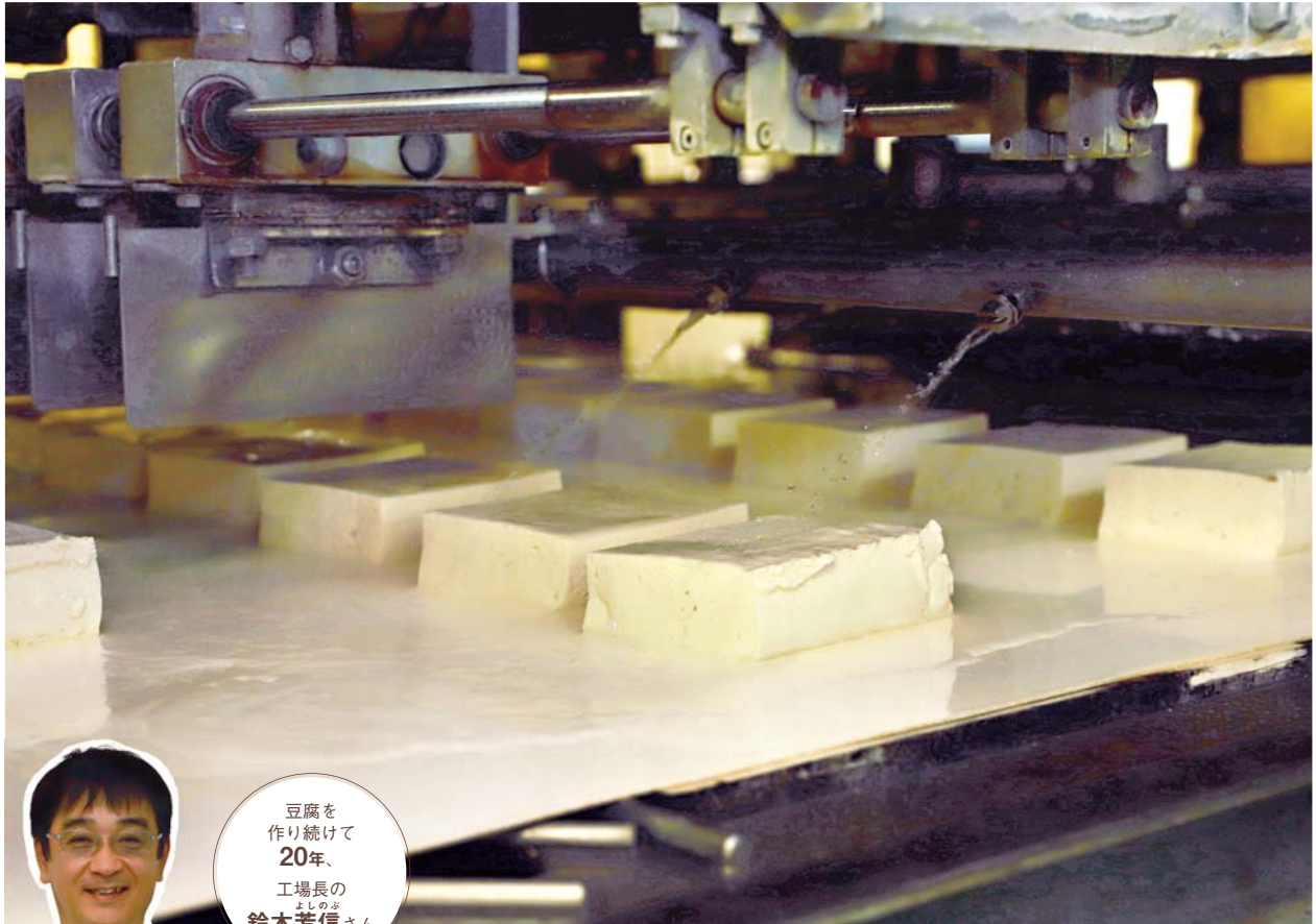
木綿豆腐が完成。パック詰め工程に自動で流れていきます
