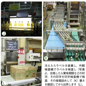
冷えたらラベルを装着し、外観検査機でラベルを検査し（写真J）、合格したら賞味期限などの印字、その印字を印字検査機で検査、その後箱詰めして（K）重さを確認してから出荷します（L）。
