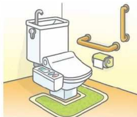
手すりの設置
